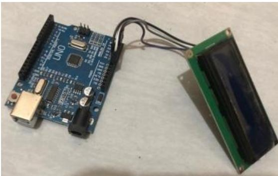
Gambar 2. Rangkaian LCD ke Mikrokontroler
